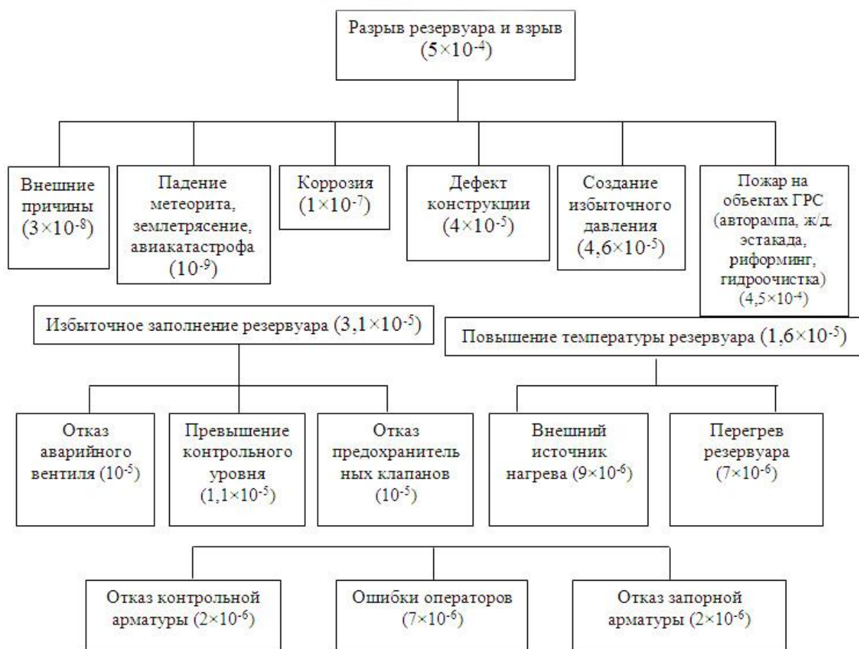
Рисунок 1.13 – «Дерево отказов» анализа причин аварийной ситуации и вероятности ее проявления на газораздаточной станции (ГРС) (пример)
